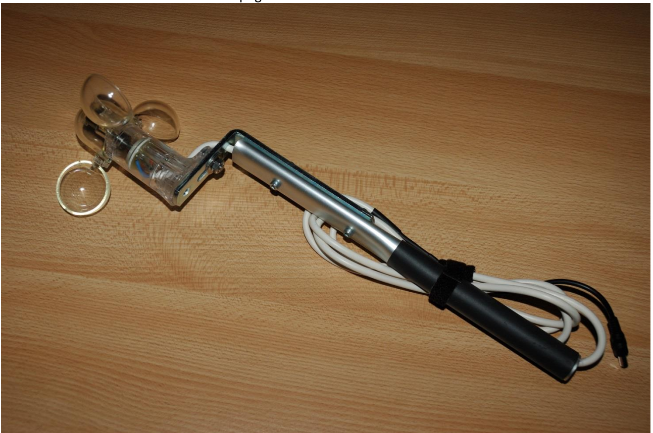
Il sensore di vento è montato su una impugnatura di alluminio
